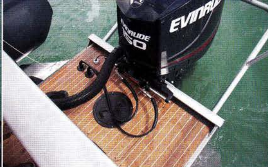
Posé sur le caisson déporté, le moteur est protégé par un roll bar.
