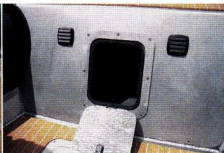
La baille à mouillage et le pont disposent de trappes fermant à clé. C'est toujours pratique.
