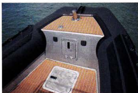
Le pont et la baille à mouillage sont recouvert du fameux antidérapant Seacork.
